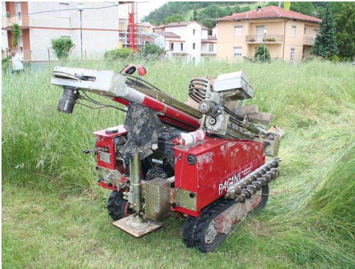
Foto 2 - Attrezzatura utilizzata per le penetrometrie dinamiche pesanti
