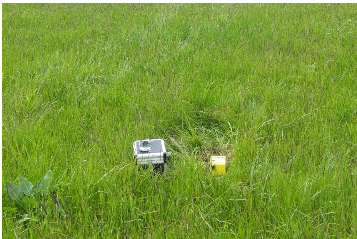
**Foto 3 - Tromometro digitale in fase di acquisizione dati**
